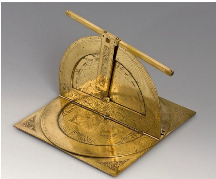
Рис.7. Теодолит Старка, 1633. Латунь. Физико-математический салон в Дрездене
