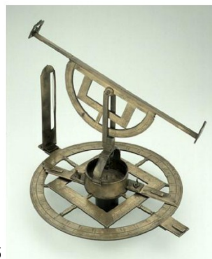
Рис.5. а - «Топографический инструмент» Диггеса [7]; б - теодолит Коула, 1586. Музей истории науки в Оксфорде
