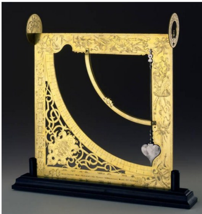
Рис.3. Квадрант с диоптрами и отвесом. Х.Трехслер-старший, 1572. Физико-математический салон, Дрезден
